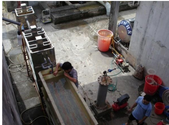
Hình 5. Hệ thống tuyển nổi áp lực pilot, thử nghiệm tại Nhà máy nước Thái Bình
